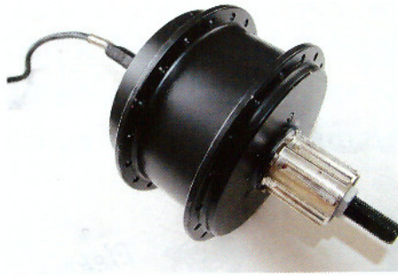
Kräftig und unauffällig klein ist der Hinterrad-Nabenmotor.
