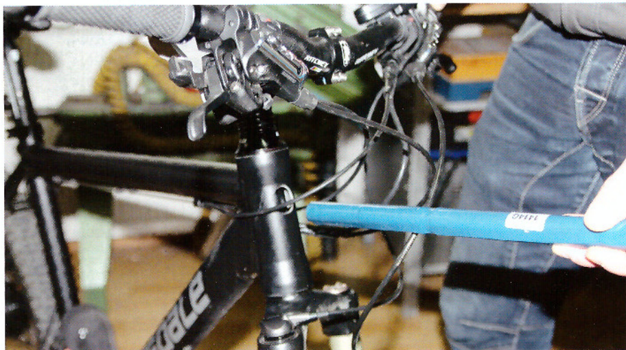
Oben: Integration als Perfektion. Remsdale versteckt den Akkustab im Ober- und Unterrohr. Clever: Das Steuerrohr-Emblem verschließt das Einschubloch.
